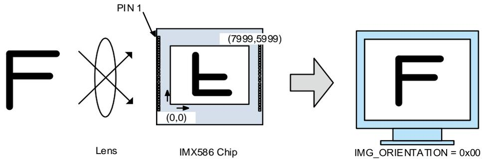
**Figure 16 Readout start position**
