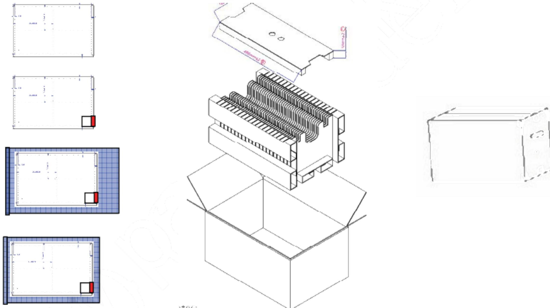
Max capacity: 40 TFT-LCD module per carton
