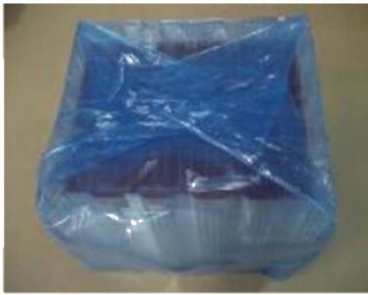
完成堆疊的 tray 放入靜電袋中，並用 tape 封口
