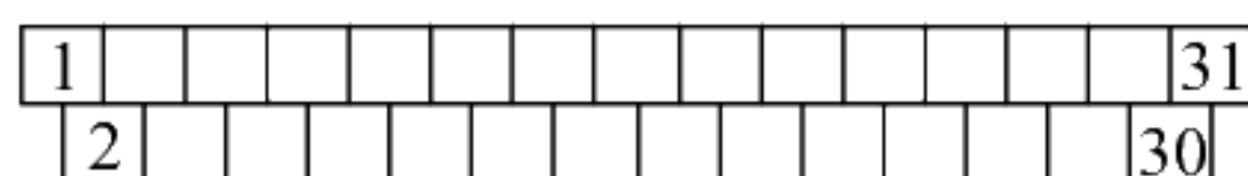
CN1 モジュール表側よりのピン配置透視図 pin arrangement from module surface (Transparent view)
