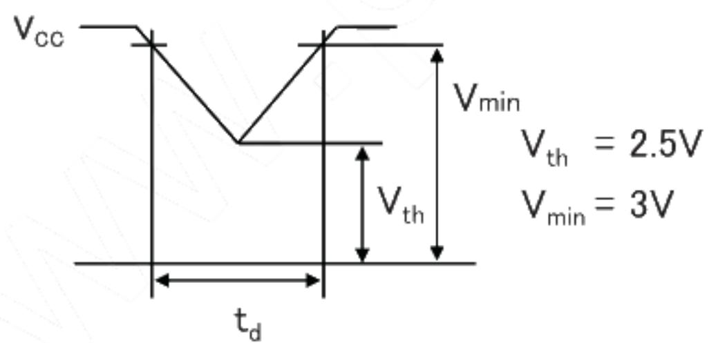
$$1) V_{th} < V_{CC} \leq V_{min}$$
